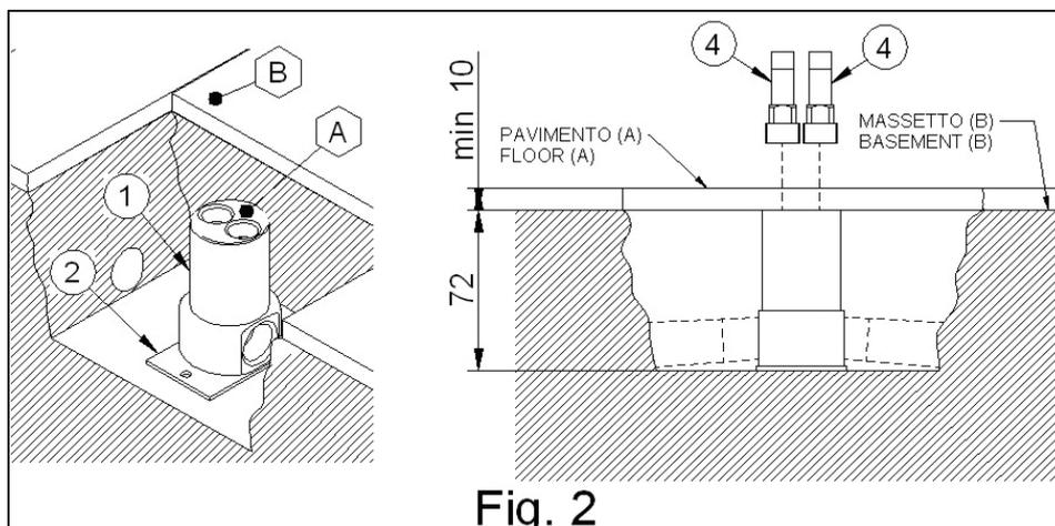
3. Visser les parties (4) sur la partie (1). Maçonner les parties encastrées jusqu'à rétablir le sol (**Fig.3**). Pendant cette opération protéger les arrivés d'eau.
