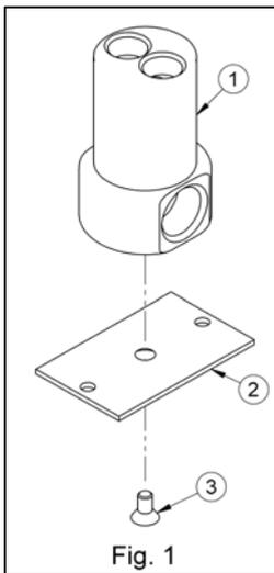
1. Fixer la platine (2) à la partie (1) avec la vis (3) (Fig.1).
