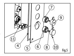
Démonter toutes les composantes de la ou des poignées et la plaque décorative (4 à 10) (Fig.5). Fermer l'alimentation d'eau principale et enlever les 2 valves d'arrêt anti-retour (11). Procéder au nettoyage des filtres en les plongeant dans un mélange d'eau et de vinaire.
